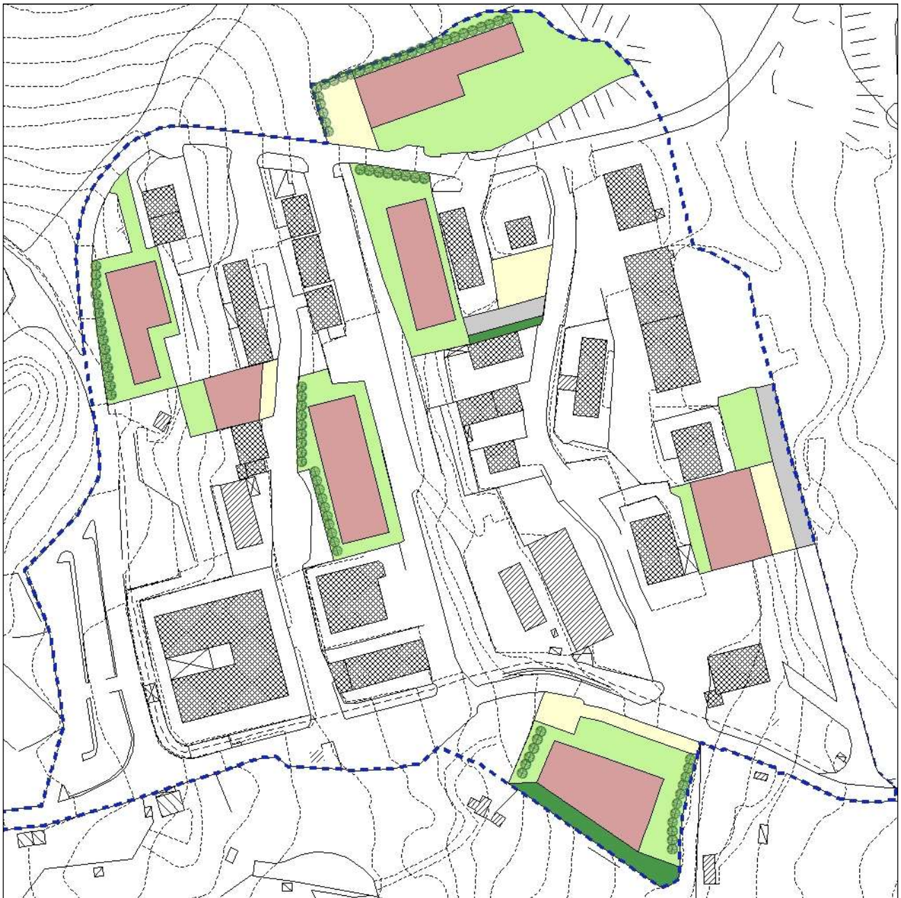
Insedimento artigianale della Rota. Planimetria schematica degli interventi previsti, con indicazione delle aree destinate alla nuova edificazione. Scala 1:2.000.
